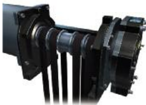
Взаимодействие плоского ремня и гладкого бочкообразного шкива
