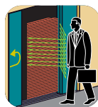
Инфракрасная защита дверного проема LAMBDA 3D (опция)
