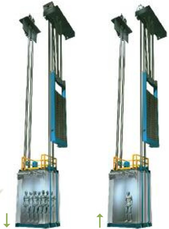
Полностью загруженная кабина при движении вниз
